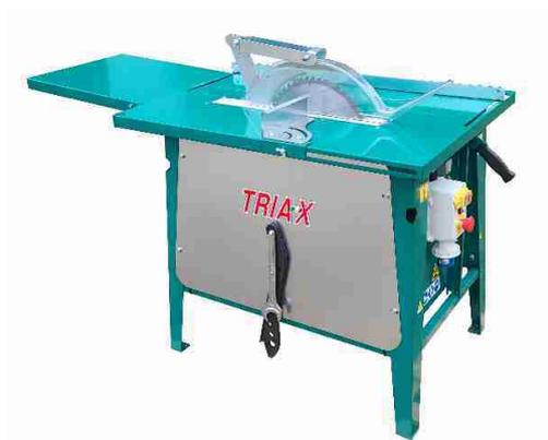
Sega circolare per legno MX350LR Triax con struttura verniciata e lama da 350 mm. Sega circolare realizzata in metallo verniciato con un motore monofase da 2,5 cavalli. La lama ha un'altezza registrabile e un diametro di 350 mm. Possiede una velocità del disco di 2800 giri/min, Un diametro del foro del disco di 25 mm e un'altezza massima di taglio di 100 mm. Dispone di un piano di lavoro di.....**Altro**
