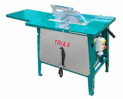
Sega circolare per legno MA315LR Triax con struttura verniciata e lama da 315 mm. Sega circolare realizzata in metallo verniciato con un motore monofase da 2,5 cavalli. La lama ha un'altezza registrabile e un diametro di 315 mm. Possiede una velocità del disco di 2800 giri/min, Un diametro del foro del disco di 25 mm e un'altezza massima di taglio di 100 mm. Dispone di un piano di lavoro di.....**Altro**
