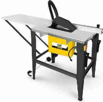
Banco sega circolare "TS 36-528", diametro 315 mm - FemiBanco sega circolare Femi con piano di lavoro 800x550 mm, estensione della base 800x400 mm e lunghezza del piano prima/dopo la lama 260/970 (con estensione). Il banco sega circolare dispone di altezza massima di taglio a 0° 83 mm e altezza massima di taglio a 45° 49 mm.....**Altro**
