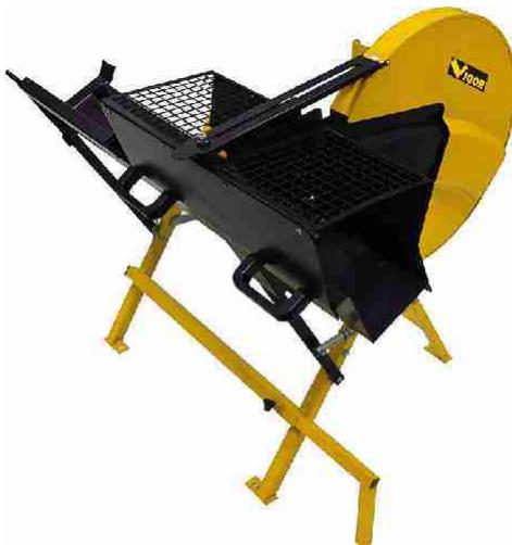
Tagliatronchi Vigor VS-400. Tagliatronchi Vigor ideale per il taglio di tronchi e rami in totale sicurezza grazie alla copertura della lama e alla culla basculante che evita il contatto accidentale. Il tagliatronchi è dotato di un motore elettrico da 230V monofase con una potenza di 2200W.
