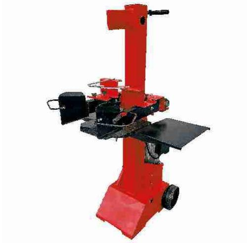
Spaccalegna verticale Blue Bird "LS 65587A" 8 tonnellate. Spaccalegna verticale elettrico potente e pratico, perfetto per spaccare legna con facilità. Equipaggiato con un motore monofase da 230V e una potenza nominale di 3000 W S6, offre una forza di spinta di 8 tonnellate. Può gestire tronchi fino a 55 cm di lunghezza e 30 cm di diametro. Il sistema di azionamento a due.....**Altro**
