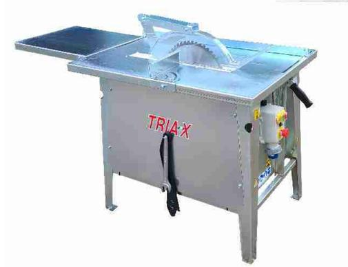
Sega circolare per legno MA315LR Triax con struttura zincata e lama da 315 mm. Sega circolare realizzata in metallo zincato con un motore monofase da 2,5 cavalli. La lama ha un'altezza regolabile e un diametro di 315 mm. Possiede una velocità del disco di 2800 giri/min, Un diametro del foro del disco di 25 mm e un'altezza massima di taglio di 100 mm. Dispone di un piano di lavoro di.....**Altro**
