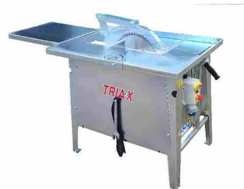
Sega circolare per legno MX350LR Triax con struttura zincata e lama da 350 mm. Sega circolare realizzata in metallo verniciato con un motore monofase da 2,5 cavalli. La lama ha un'altezza regolabile e un diametro di 315 mm. Possiede una velocità del disco di 2800 giri/min, Un diametro del foro del disco di 25 mm e un'altezza massima di taglio di 100 mm. Dispone di un piano di lavoro di.....**Altro**
