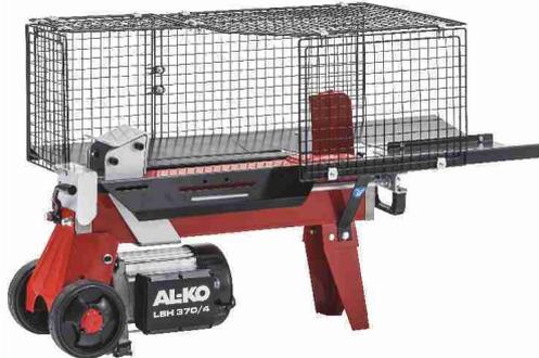
Spaccalegna orizzontale con motore elettrico 230V, potenza di 1,5 KW e pressione massima di 4 tonnellate. Lunghezza massima tronco: 370 mm. Diametro massimo tronco: 250 mm. Doppie comandi separati per garantire la massima sicurezza, questo spaccalegna è poco ingombrante e facilmente trasportabile grazie alle ampie e robuste ruote.
