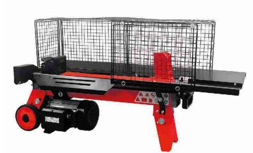
Spaccalegna orizzontale elettrico Blue Bird "LSHE 7000" 7 tonnellate. Spaccalegna orizzontale elettrico progettato per spaccare ceppi facilmente, quasi senza la necessità di sollevarli. Dotato di un motore monofase da 2300 W/230V, offre una potenza di spinta di 7 tonnellate. Può gestire ceppi fino a 52 cm di lunghezza e 25 cm di.....**Altro**
