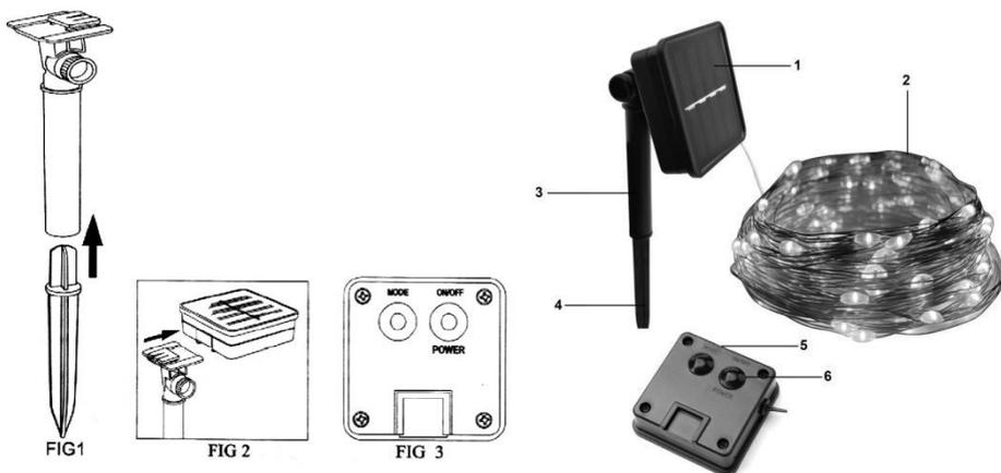
4 - Premere il pulsante "Mode" per cambiare la modalità luce da intermittente a continua (operazione che sarà visibile e valida solo al buio).
