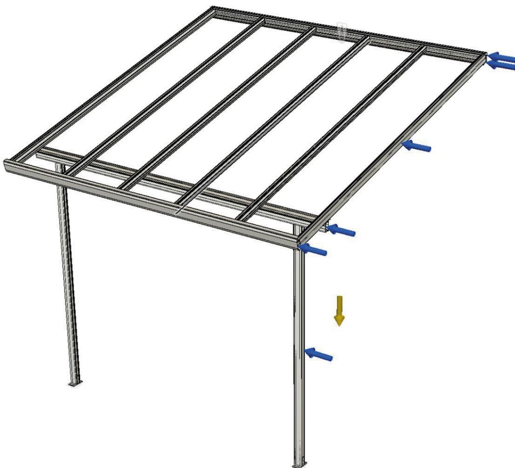
Questa è solo la statica della costruzione in alluminio. In questo caso non sono stati presi in considerazione i pannelli a camera cava in policarbonato. I pannelli a camera cava influenzerebbero il risultato in modo tale che il tetto avrebbe una stabilità ancora maggiore. Si può quindi supporre che le piastre possano essere trascurate.
