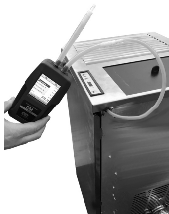
Fig. 27 - Collegamento pressostato digitale
