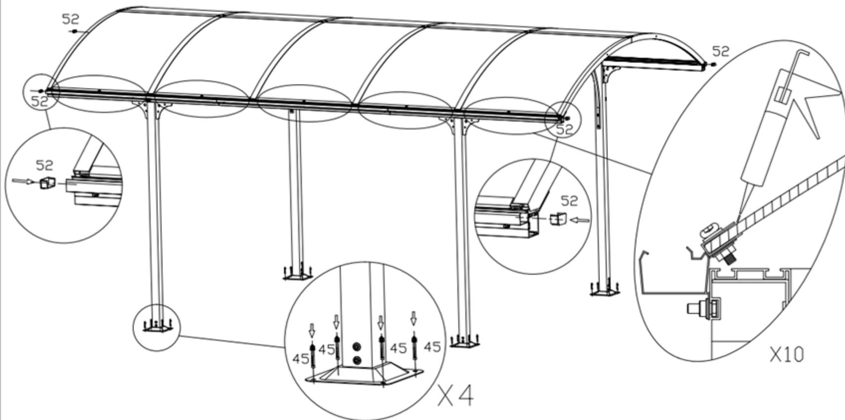
Pour maximiser l'étanchéité des gouttières, appliquer un mastic d'étanchéité d'extérieur (non fourni) à toutes les pièces en contact.
