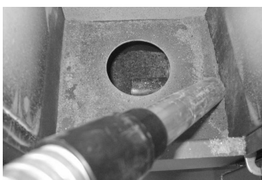
Fig. 38 - Pulizia vano cassetto cenere
