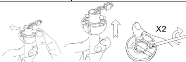
Inserire sull'estremità superiore dell'asta il perno attraverso il foro e fissarlo tramite le due viti.
