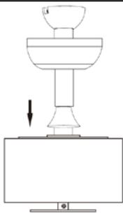
Abbassare la calotta inferiore fino in fondo.
