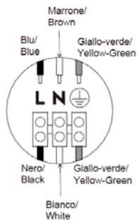
Corpo motore/Fan motor assembly
