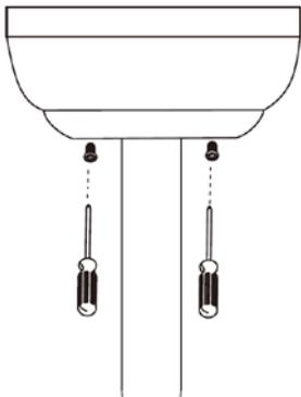
Sollevare la calotta, allineare le asole a mo' di serratura con le viti della staffa di fissaggio (1) e ruotare in senso antiorario fino al bloccaggio. Verificare che il ventilatore sia saldamente fissato al soffitto, prima di procedere a qualsiasi operazioni di accensione.
