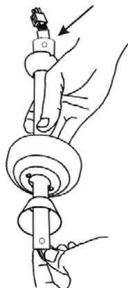
Infilare il supporto dell'asta (se precedentemente sfilato o non presente) in maniera che sia posizionato sul lembo alto (estremità tre fori), poi la calotta superiore (2) e la calotta inferiore (4); inserire i cavetti elettrici attraverso la cavità dell'asta. I fili vanno inseriti dal basso verso l'alto. Assicurarsi che nessun filo sia al di fuori.
