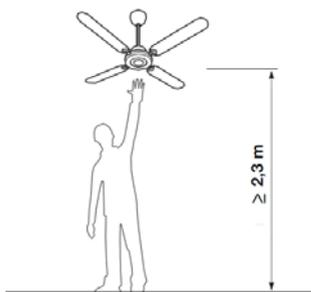
Fissare la Staffa Di Fissaggio al soffitto seguendo queste indicazioni. Prima di forare il soffitto accertarsi di non danneggiare condotte interne e che i dispositivi di ancoraggio non compromettano la resistenza del soffitto.
