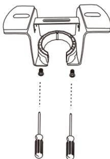
Allentare le due viti per il bloccaggio della calotta superiore.
