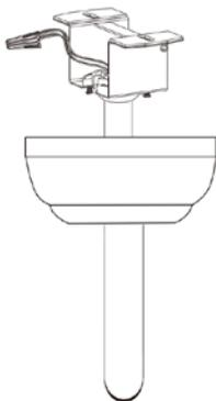
Inserire l'estremità semi-sferica dell'asta attraverso lo spazio predisposto: allineando il dentello presente sulla staffa alla corrispettiva sede presente nell'estremità emisferica, verificare che i fili elettrici (sia dell'asta e della staffa di fissaggio) siano orientati in modo da non ostacolare l'operazione.
