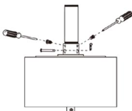
Inserire l'asta (il supporto asta deve risultare nella parte superiore) sul corpo motore nell'estremità superiore, in maniera che i fori risultino coassiali e inserire l'apposito perno e fissarlo tramite la coppiglia (che deve essere inserita in modo da impedire che sia perno che coppiglia possano sfilarsi). Successivamente bloccare l'asta avvitando le due viti di sicurezza.
