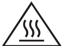
**Attenzione:** La superficie accessibile può essere calda durante il funzionamento.
