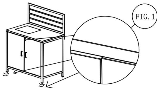
VERIFICARE CHE I 4 PIEDINI REGOLABILI IN ALTEZZA SIANO TUTTI FISSATI ALLA STESSA MISURA. SE LE DUE PORTE NON DOVESSERO ESSERE ALLINEATE VEDI FIG 1, RUOTARE UNO DEI PIEDINI ANTERIORI IN SENSO ORARIO O ANTIORARIO AFFINCHÉ LE DUE PORTE RISULTINO ALLINEATE.
